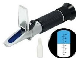
Exemplo de um Refratômetro Manual
