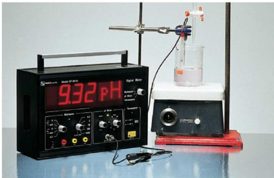
Figura 1.2. — Aparelho medidor de pH para monitorizar uma titulação potenciométrica
